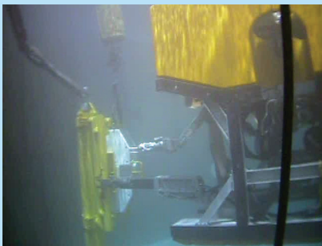
ROV retraindo ferramenta do sensor durante teste de qualificação no tanque
